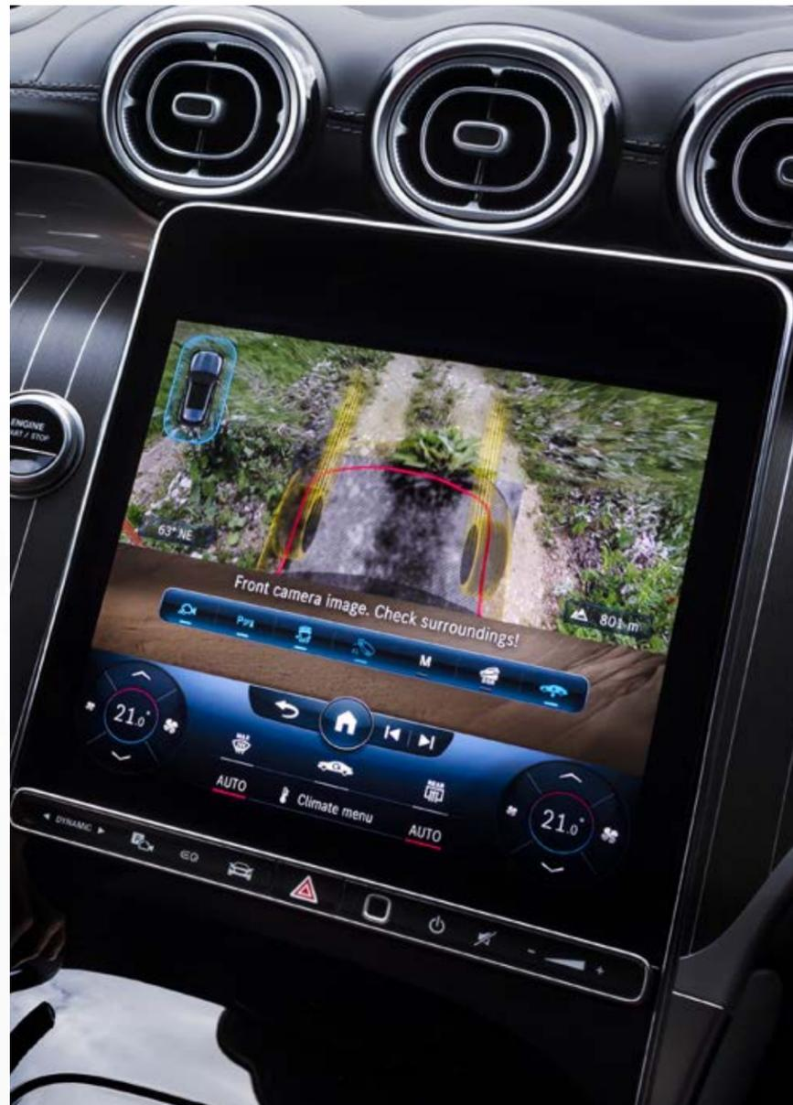
**Pantalla MBUX “off-road” con función “capó transparente”:** vista virtual del suelo bajo el vehículo a través del compartimento del motor (con una velocidad hasta 8 km/h)
